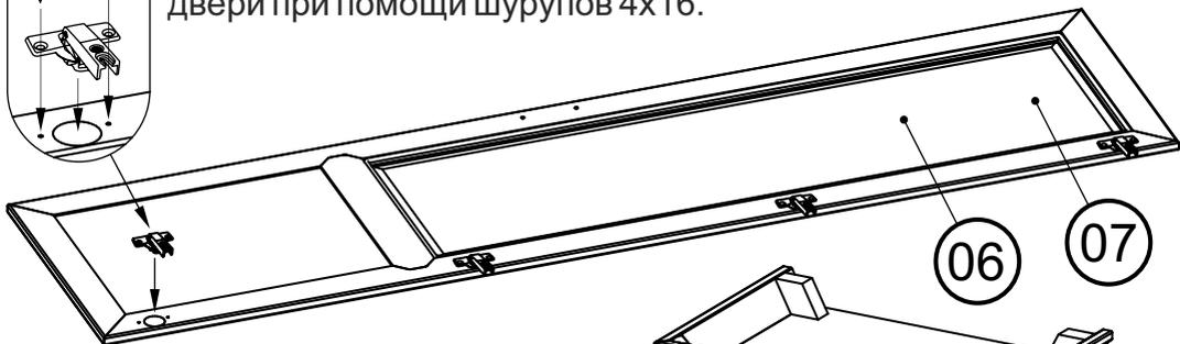
На шкаф установить двери. Отрегулировать согласно приведенной ниже схемы. Выровнять фасад по высоте. При необходимости подложить под опоры пластиковую подкладку.
