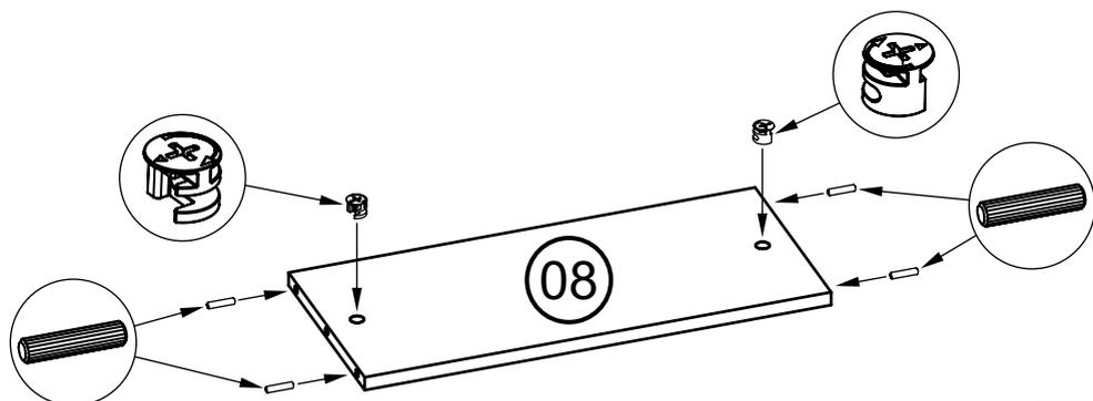
Позади стенки задней с зеркалом 13 установить монтажный брусок 07 и стенку жесткости 08 отверстиями на соединительные винты стенки вертикальной левой 03 (02.03).
