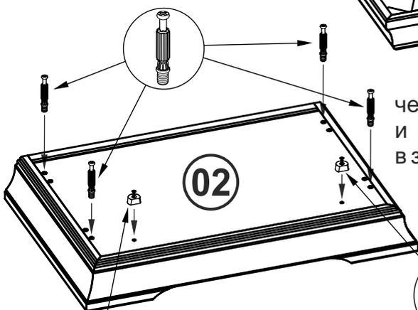
Установить на цоколь 02 четыре соединительных винта и один ограничитель двери - в зависимости от исполнения.
