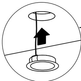
В отверстия на вертикальных стенках 03 и 04 (02.03 и 02.04) установить полкодержатели с присоской для стеклянных полок и полкодержатели для деревянной полки.
