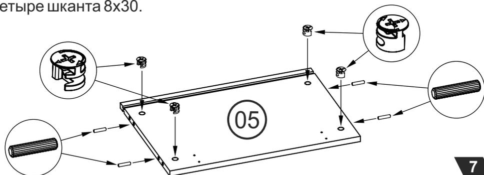
Брусок монтажный 07 оборудовать двумя эксцентриками. В отверстия на торцевых кромках установить четыре шканта 8x30.
