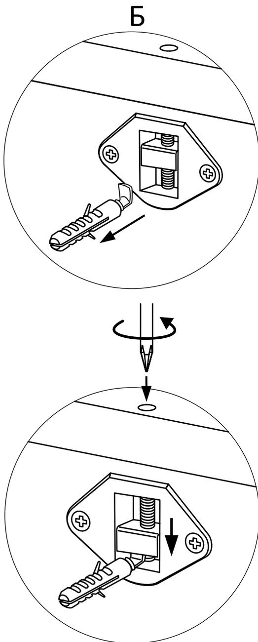
Отрегулировать отверткой с крестообразным наконечником подвес так, чтобы зацеп перекрывал крючок. Отверстия для регулировки закрыть заглушками  $\varnothing 6$  мм.
