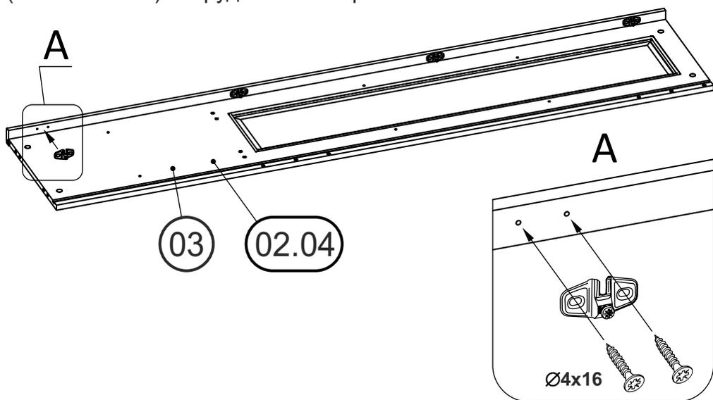
Стенки вертикальные левую 03 и правую 04 для левого шкафа (02.03 и 02.04 для правого) оборудовать четырьмя эксцентриками и четырьмя винтами соединительными. В отверстия на торцевых кромках установить четыре шканта 8x30.
