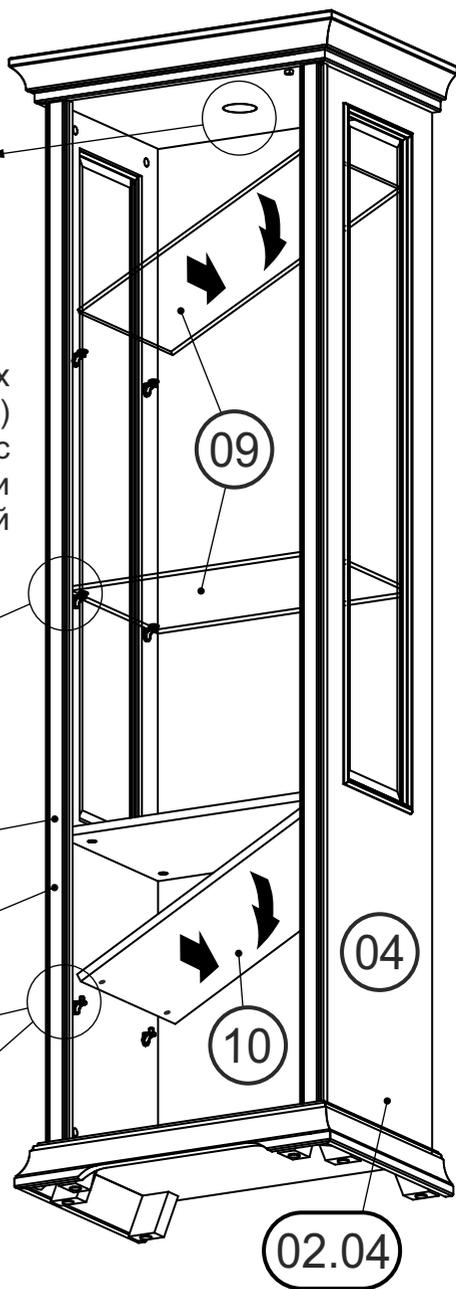
Для этого полки 09 и 10 необходимо повернуть для того, чтобы полки вошли в проем между вертикальных стенок 03 и 04 (02.03 и 02.04), затем придать полкам горизонтальное положение и установить на полкодержатели.
