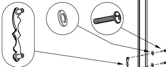
На стенку горизонтальную среднюю установить демпферы при помощи шурупов  $\text{Ø}3,5 \times 16$ .
